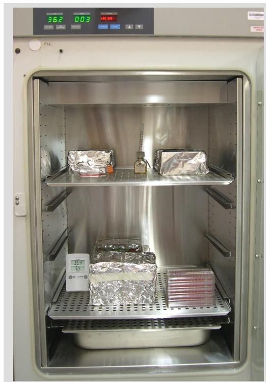
Figura 11. Placas embrulhadas em alumínio e levadas à estufa a 37°C com 5% de CO<sub>2</sub> no ar.
