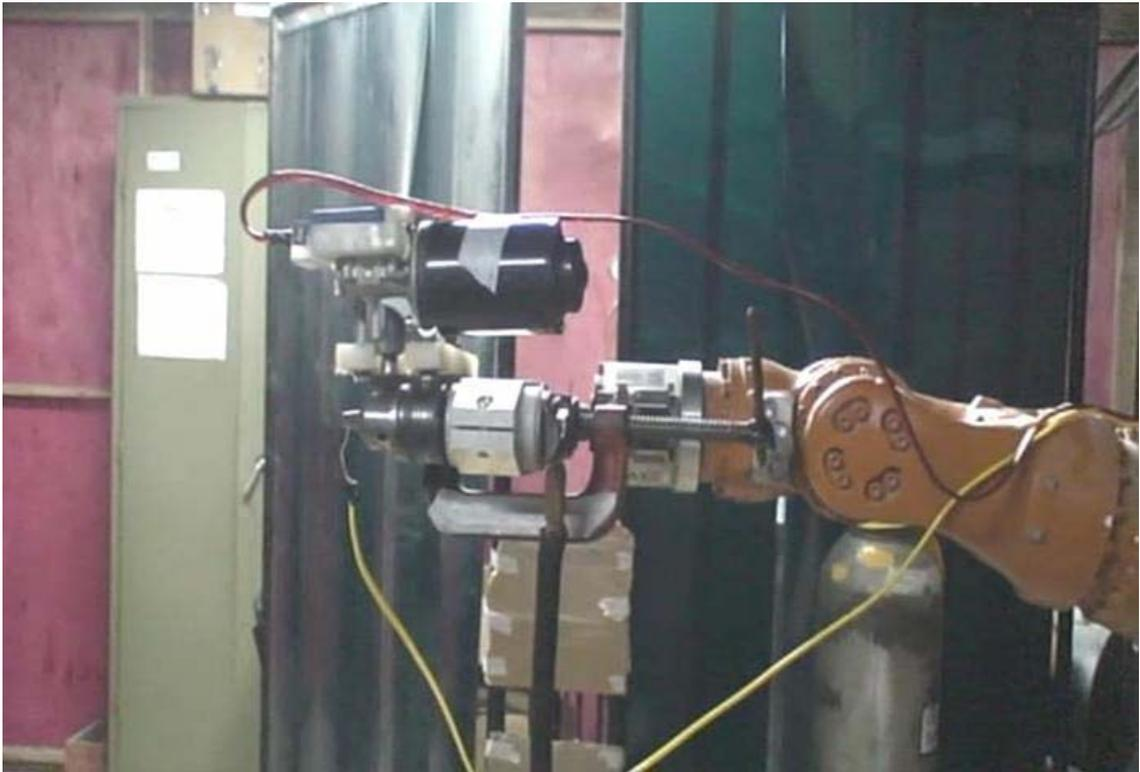
FIG 4.3 - Posição inicial do Manipulador – Mandril fechado.
