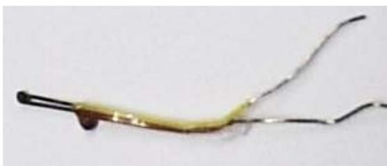
FIG. 3.5 - Termopar com juntas soldadas.
