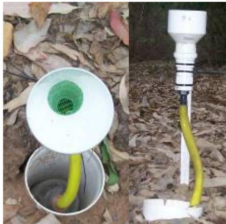
**Figura 5.9 – Vista superior e lateral do interceptômetro.**
